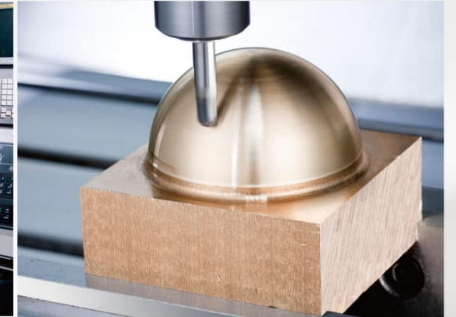
3D半圓球立體模具切削測試
